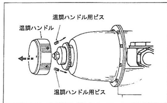
② 見えてきたスプリング固定ナットをスパナで外して下さい。
