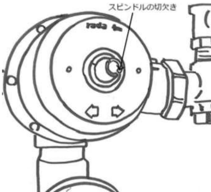
①スピンドルの切欠きにマイナスドライバーなどで、反時計方向に回した後、(低温側)温水を出して下さい。
