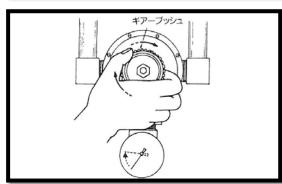
3) 希望する温度になれば元の様に組み立てて下さい。「最高温度の設定」は温調ハンドル裏側の凹み部分がカバーのストップピンに当たり、それ以上時計方向に回らない位置で温調ハンドルをセットして下さい。
