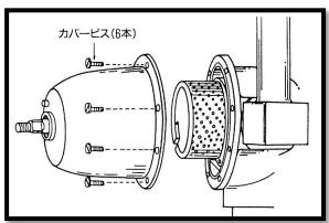
7) ポートスリーブを外し、ポートピラー の2本のピラービスをゆるめて外してさ い。その際、ピラージョイントを新しい ものと取り替えて下さい。
