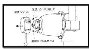
2) 見えてきたギヤーブッシュを手で少しずつ時計方向に回して下さい。 温水温度が上昇して行きます。
