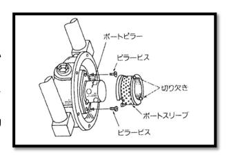
8) 新しいポートスリーブをポートピラー にはめて下さい。この時、ポートスリー ブの切り欠き部分の長い方をボディー 側に、切り欠きが2か所ある方をカバー 側にして下さい。
