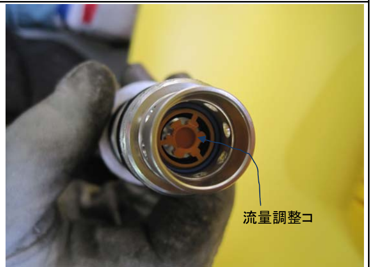
6. キャップの内側に、流量調整コマがありますので目詰まりを確認、清掃、交換します。
