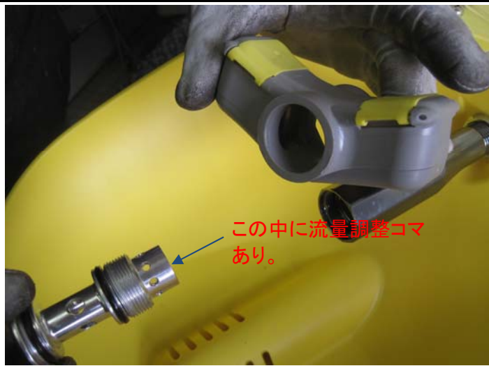
3. キャップを抜き取ると、洗眼ノズル部が外れます。
