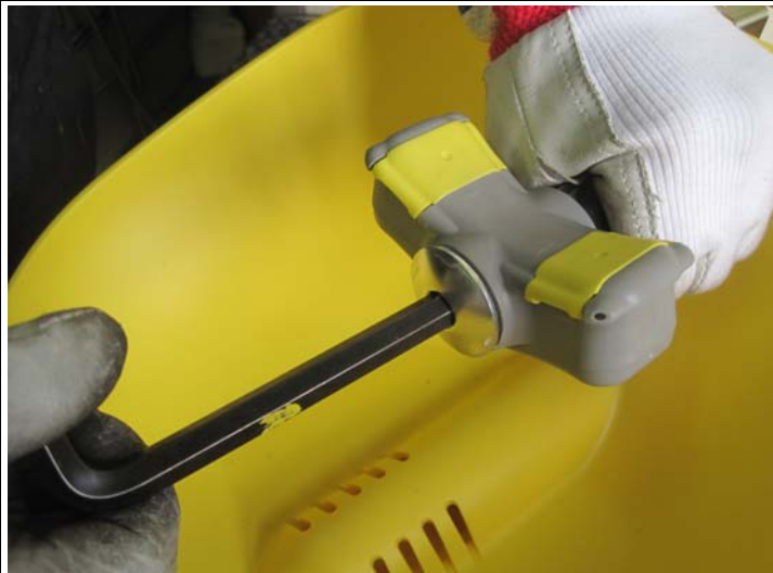
1. 3/8"の六角レンチでキャップを外します。
