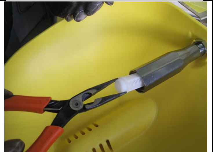
4. ボディー内に残ったスクリーンをプライヤーで取りだしま
