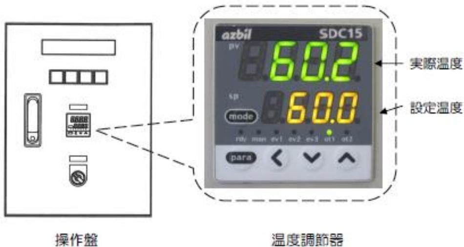
設定温度変更方法 (設定温度60℃を40℃に変更する例)
