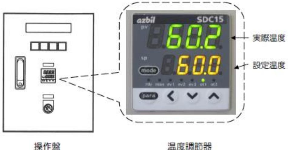
設定温度変更方法 （設定温度60°Cを40°Cに変更する例）
