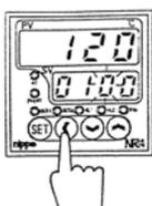
PV/SV モードで SET キーを押して SV モードにします。SV 表示器の最低位桁が点滅表示となります。点滅表示の桁が設定可能です。
