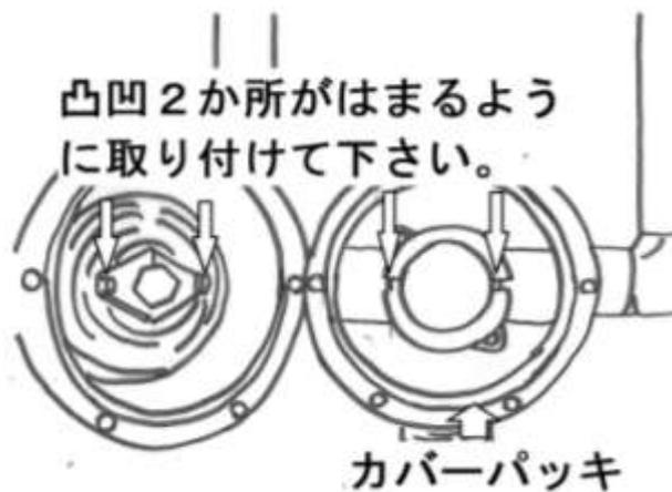
②古いカバーパッキンの残渣が残らないよう完全に取り除き、新しいパッキンに取付けてください。
