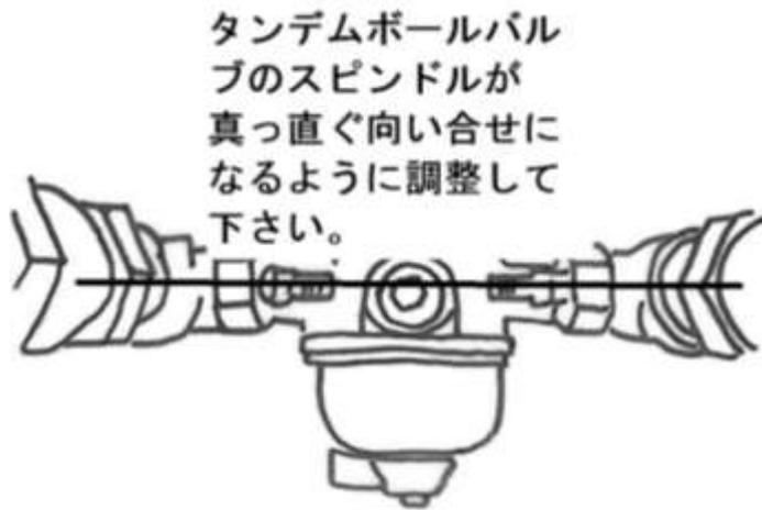
⑥タンデムレバー・レバーハンドルを取り付け、何度か開閉し正常に開閉できるか確認して下さい。
