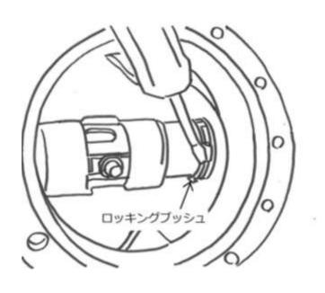
④ ③で**ロッキングリング**をロッキングブッシュの根元まで送り込んだ後、ロッキングブッシュを同じ要領で時計方向へ回しボディーへねじ込むように回してチューブ&シャトルアッセンブリーを外して下さい。
