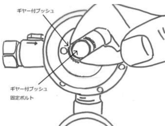
②ギヤ付ブッシュをプライヤーなどで固定し、ギヤ付ブッシュ固定ナットを外して下さい。
