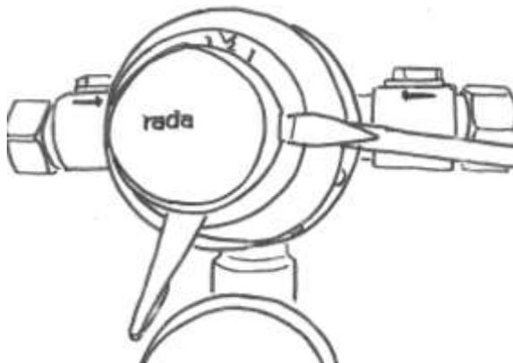
①ネームプレート側面にある凹みにマイナスドライバーをさし込みネームプレートを外して下さい。(はめ込み式です)
