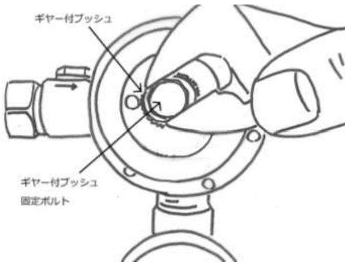
① プレーシャーワッシャー・ギヤ付ブッシュ・ギヤ付ブッシュ固定ナットの順に取り付けてください。(ギヤ付ブッシュをプレーヤーなどで固定しナットを締め付けて下さい。)ギヤ付ブッシュを反時計方向に回した後、温水を出して下さい。
