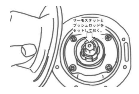
⑥ カバーをセットした後、カバービス(6本)を均等に締め付け下さい。 「カバーシュラウド」を取付け下さい。
