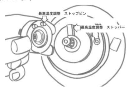
セット後温水を出しながら「温調ノブ」を操作し正常に温度調整ができるか確認して下さい。 ※温度調整ができない場合は、カートリッジの給湯・給水の取付け方向が間違っていないか確認 して下さい。
