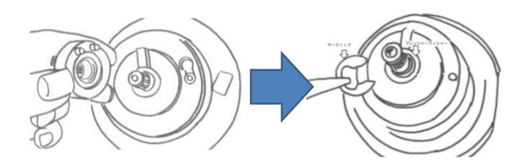
③ カバービスを外しカバーを取り外して下さい。
