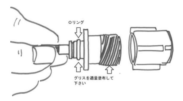
④ 新しいドライブメカニズムパック又はOリング交換済みの物をカバー内側からセットし「プレッシャーワッシャー」・「サークリップ」の順に組み立てて下さい。
