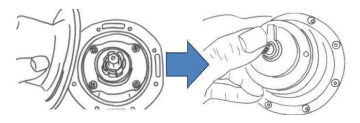
③ ドライブメカニズムパック交換時又はOリング交換時は下記に箇所に付属のグリス (シリコングリス)を適量塗布してから取付け下さい。
