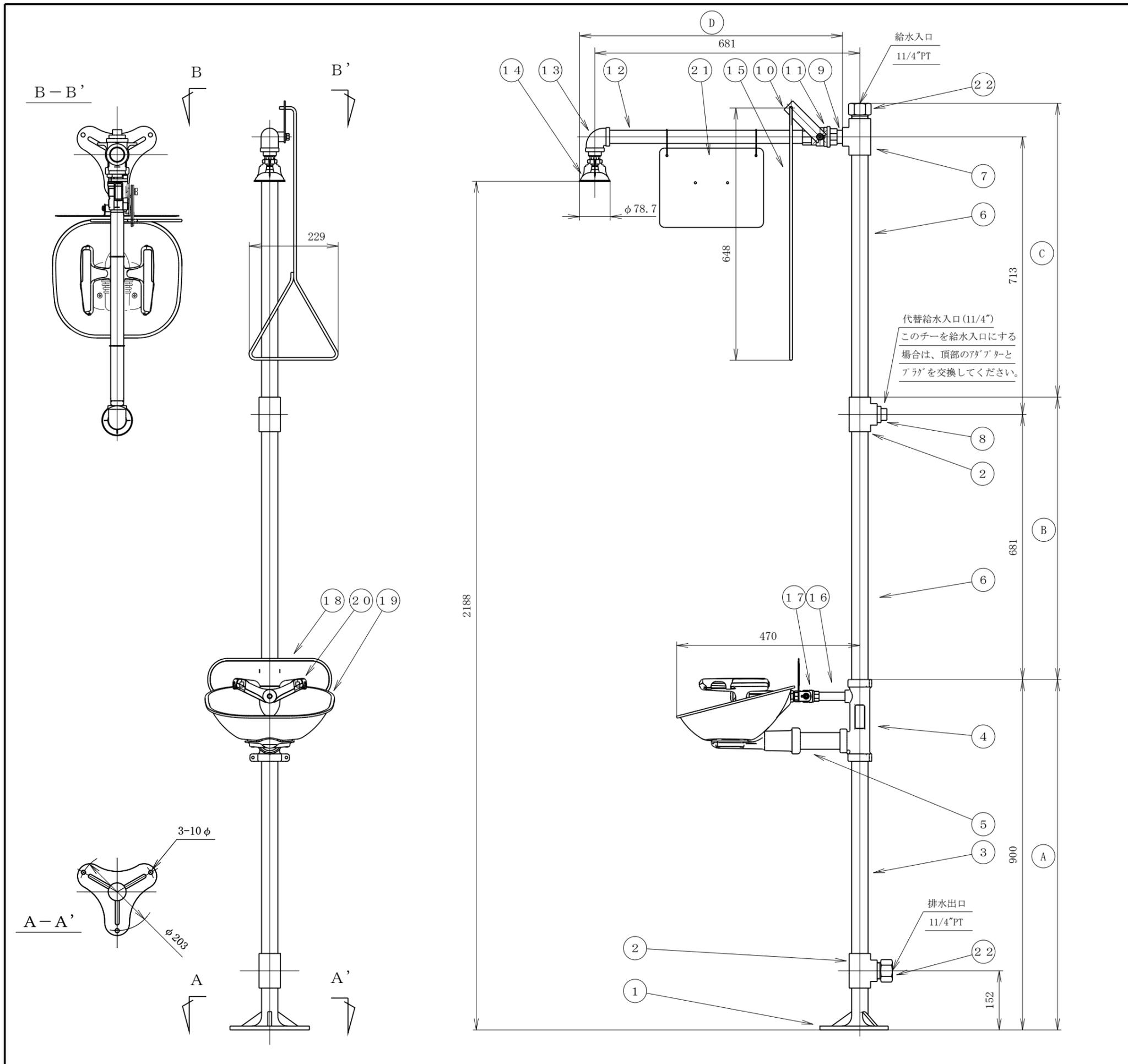
\*本ユニットに使用されるパイプ継手は、亜鉛メッキの上に、黄色の活性ポリウレタンコーティング (BRADTECT) が施されています。
