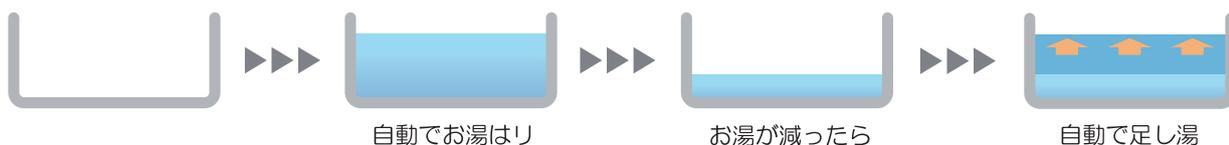
コントローラは満水停止、補給開始、ポンプ停止と解除の4点の制御をします。
